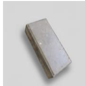
Gambar 7. Paving Block hasil produksi dari limbah plastik
