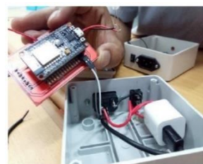
Gambar 4 Mesin kehadiran berbasis RFID yang telah berhasil dirakit
