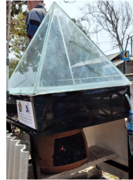
Gambar 2 Alat destilasi air laut dengan tambahan tungku untuk mempercepat destilasi
