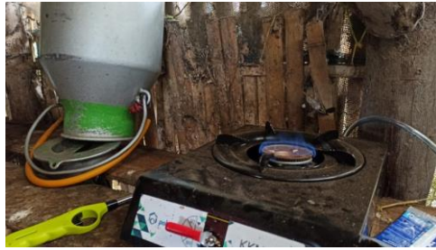
Gambar 10. Ujicoba Gas Hasil Reaktor Biogas
