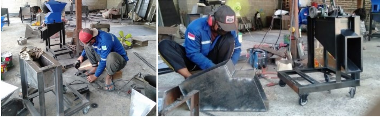
Gambar 4. Pembuatan dan Perakitan Prototype Mesin Mekanik Chopper Multifungsi
