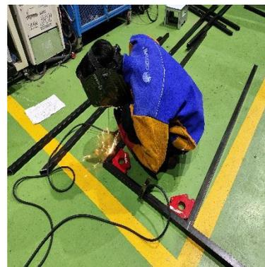
Gambar 4. Proses pengelasan menggunakan mesin las SMAW.
