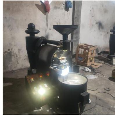
Gambar 1. Hasil rancang bangun mesin *roasting*.
