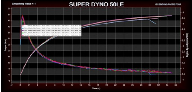
Grafik 1. Hasil Pengukuran Torsi dan RPM
