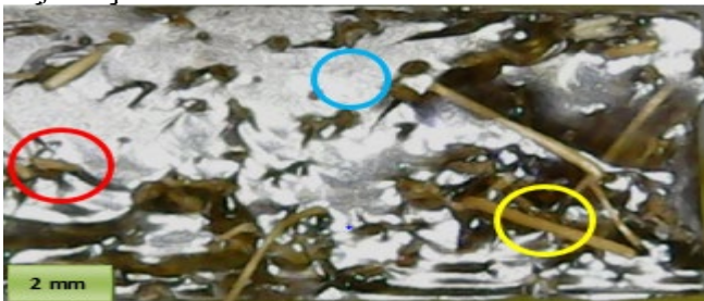
Gambar 11. Patahan spesimen bending variasi serat 20 : 80
