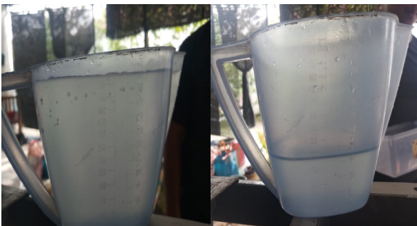
Gambar 16. Uji valve air 6 detik
