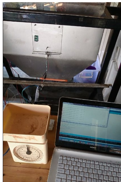
Gambar 14. Pengujian valve tepung menggunakan Load Cell
