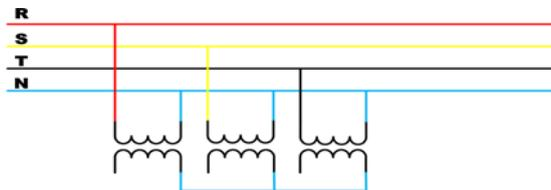
Gambar 4. Rangkaian Sensor Tegangan
