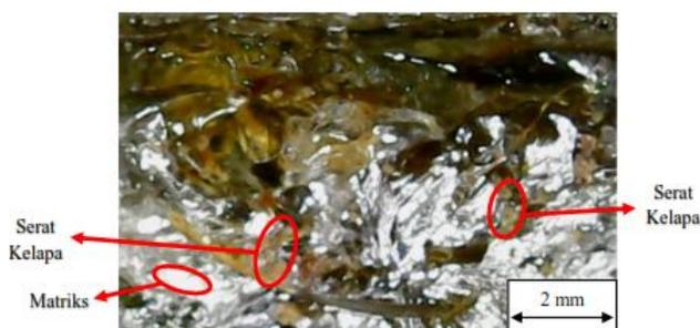
Gambar 6 Foto makro dari pengujian *bending* yang terbaik
