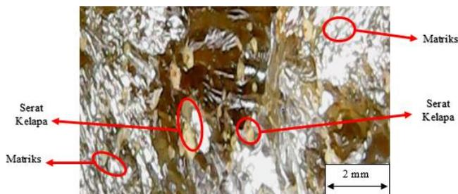
Gambar 5 Foto makro dari pengujian tarik yang terlemah
