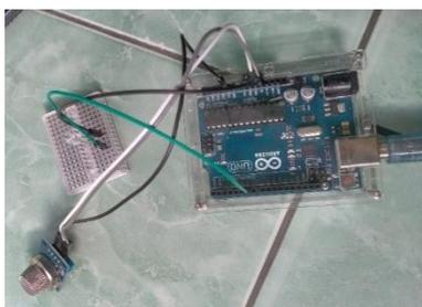
Gambar 17. Pengujian sensor MQ-2
