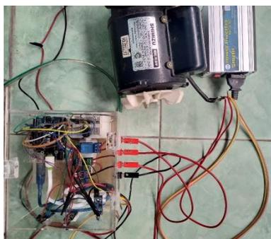
Gambar 20. Pengujian sistem kontrol dengan sumber inverter 220VAC
