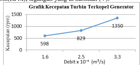
Gambar 11 Grafik kecepatan turbin terkopel generator variasi blade 6
