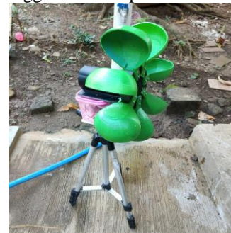
Gambar 3. Hasil Pembuatan Turbin pelton
