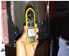
Gambar 12. Pengujian Kecepatan Angin Turbin Darius Eggbeater dengan Posisi 0 Derajat Tanpa Rangkaian Step Up
