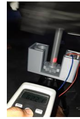
Gambar 34. Pengujian RPM Turbin Darius Eggbeater dengan Posisi 45 Derajat Dengan Rangkaian Step Up
