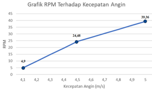
Gambar 45. Grafik Turbin Darius Eggbeater Posisi 90 derajat Tanpa Rangkaian Step Up Perbandingan RPM terhadap Kecepatan Angin (m/s)
