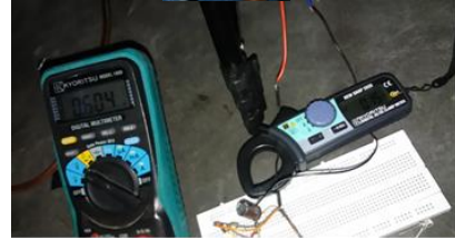
Gambar 29. Pengujian Tegangan dan Arus Turbin Darius Eggbeater dengan Posisi 45 Derajat Tanpa Rangkaian Step Up
