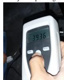
Gambar 43. Pengujian RPM Turbin Darius Eggbeater dengan Posisi 90 Derajat Tanpa Rangkaian Step Up
