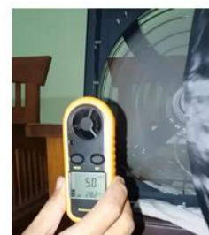
Gambar 42. Pengujian Kecepatan Angin Turbin Darius Eggbeater dengan Posisi 90 Derajat Tanpa Rangkaian Step Up
