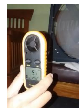
Gambar 18. Pengujian Kecepatan Angin Turbin Darius Eggbeater dengan Posisi 0 Derajat Dengan Rangkaian Step Up
