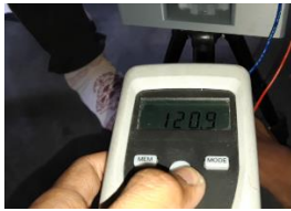
Gambar 19. Pengujian RPM Turbin Darius Eggbeater dengan Posisi 0 Derajat Dengan Rangkaian Step Up
