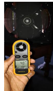
Gambar 48. Pengujian Kecepatan Angin Turbin Darius Eggbeater dengan Posisi 90 Derajat Dengan Rangkaian Step Up
