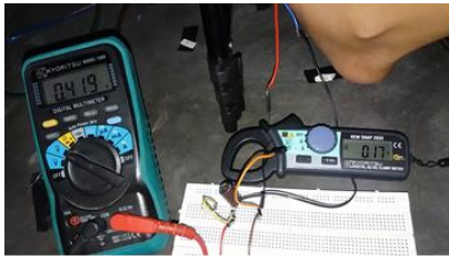
Gambar 44. Pengujian Tegangan dan Arus Turbin Darius Eggbeater dengan Posisi 90 Derajat Tanpa Rangkaian Step Up
