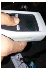
Gambar 27. Pengujian Kecepatan Angin Turbin Darius Eggbeater dengan Posisi 45 Derajat Tanpa Rangkaian Step Up
