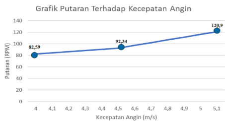
Gambar 21. Grafik Turbin Darius Eggbeater Posisi 0 derajat Dengan Rangkaian Step up Perbandingan RPM terhadap Kecepatan Angin (m/s)
