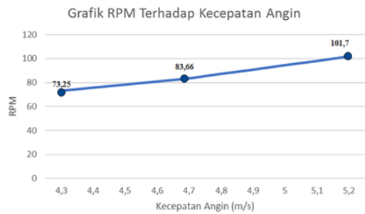
Gambar 30. Grafik Turbin Darius Eggbeater Posisi 45 derajat Tanpa Rangkaian Step Up Perbandingan RPM terhadap Kecepatan Angin (m/s)
