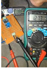
Gambar 20. Pengujian Tegangan dan Arus Turbin Darius Eggbeater dengan Posisi 0 Derajat Dengan Rangkaian Step Up
