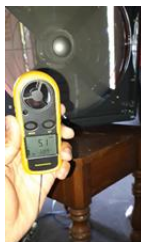
Gambar 33. Pengujian Kecepatan Angin Turbin Darius Eggbeater dengan Posisi 45 Derajat Dengan Rangkaian Step Up
