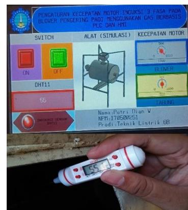
Gambar 20. Pengukuran suhu kondisi motor cepat
