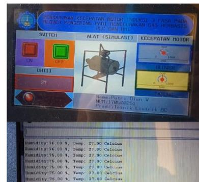
Gambar 9. Perbandingan nilai suhu Arduino dan HMI
