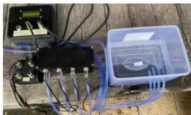
Gambar 10. Microgreens cultivation dengan modular system kontrol penyiraman
